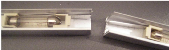
Bild 4 Såga av al listen med en skarp bågfil
